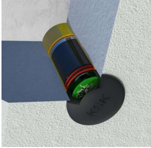
Radarowy czujnik zajętości w kostce brukowej
